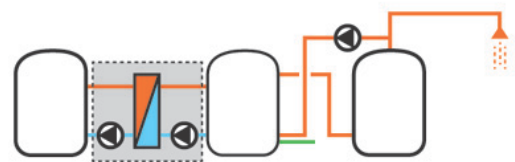
Phase pré chauffage TS
